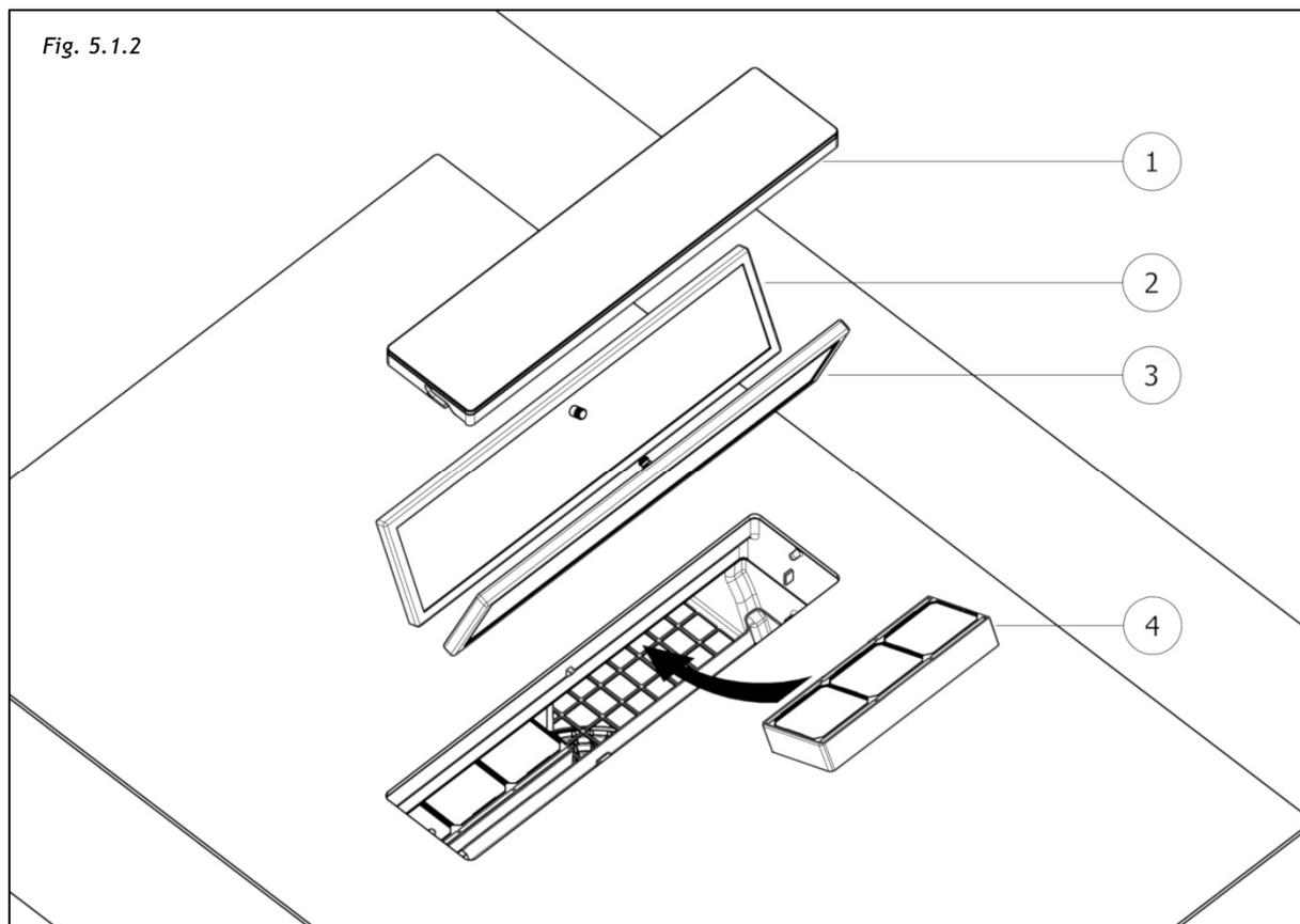
Pour régénérer thermiquement les filtres anti-odeurs céramiques long life, ils doivent être placés au four à 100°C pendant 2/3 heures. La régénération correcte assure une efficacité de filtration constante pendant 5 ans.
