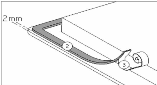
Fixer le joint (2) à deux millimètres du bord extérieur du verre, après avoir retiré la feuille de protection (3).
