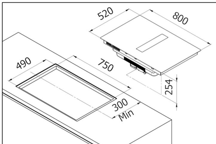
Pour effectuer l'INSTALLATION AFFLEURANTE, percer et fraiser le plan de travail le long du bord du trou d'installation, en respectant les mesures indiquées :
