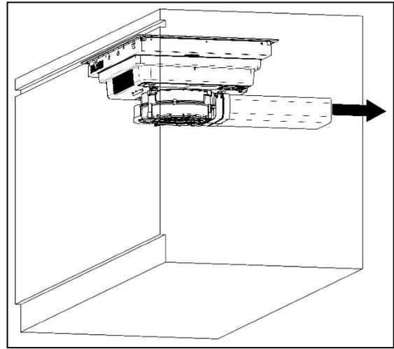
L'utilisation de tubes longs, avec plusieurs coudes, annelés et d'une section inférieure à celle de la sortie du moteur entraînera une diminution des performances d'extraction et une augmentation possible du bruit.
