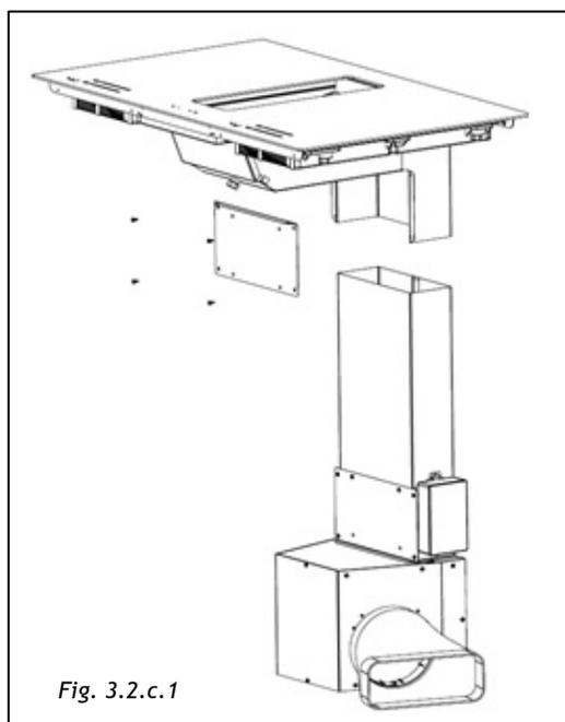
Si la longueur du tube métallique n'est pas suffisante pour atteindre le boîtier supérieur, elle peut être augmentée en déplaçant le tube à l'intérieur du boîtier moteur.
