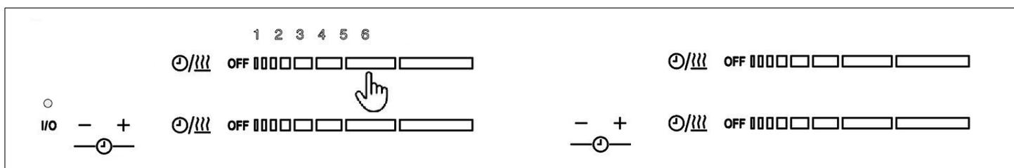
Pour éteindre une zone de chauffe, l'utilisateur doit appuyer sur la partie inférieure du curseur de l'élément, un bip retentit et l'élément de chauffe s'éteint. L'indication de chaleur résiduelle apparaît sur l'écran si de la chaleur résiduelle sort.
