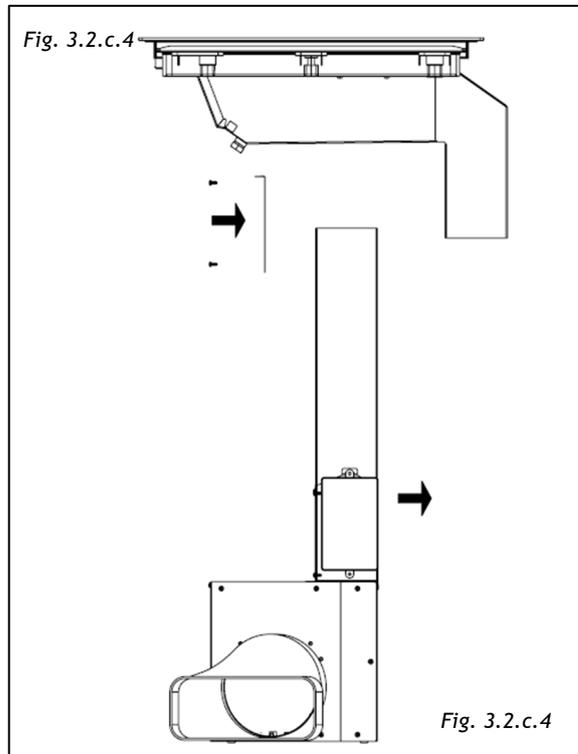
Pour loger correctement les tuyaux d'évacuation d'air, il est nécessaire d'utiliser des tuyaux et des raccords qui leur permettent de passer sous les meubles de cuisine, dans l'espace entre la base du meuble et le sol, normalement recouvert d'un socle.
