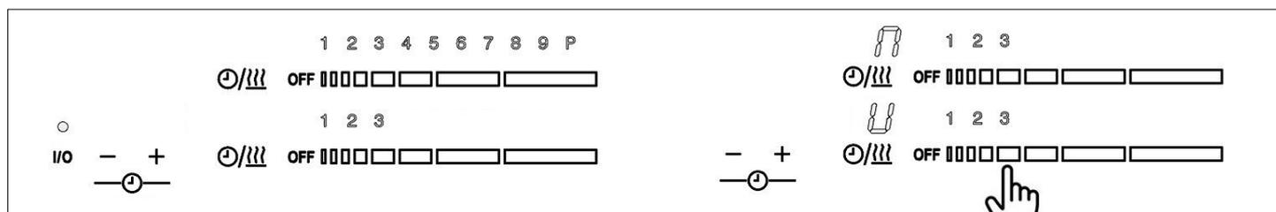
Lorsque les éléments de chauffe fonctionnent en tant qu'élément de chauffe à Bridge « Pont », les niveaux de puissance sélectionnables sont de 1 à 9, il n'est pas possible de sélectionner le niveau de puissance du booster (P). Lorsque les éléments de chauffe fonctionnent individuellement, les niveaux de puissance sélectionnables vont de 1 à P.
