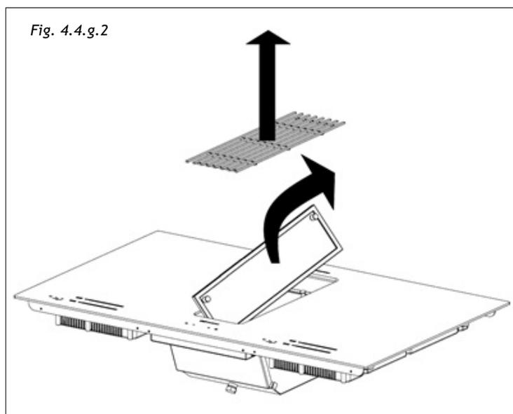
Après avoir effectué ces opérations, l'intérieur du bac peut être nettoyé et séché par le dessus. Après le nettoyage, repositionner tous les composants et la grille en effectuant les opérations ci-dessus (Fig. 4.4.g.2) dans l'ordre inverse.
