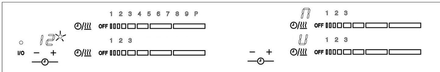
➤ Si l'élément de chauffe 1 et l'élément de chauffe 2 sont en minuterie en même temps (Touch Control à gauche) : le temps restant le plus court s'affiche et son LED de minuterie clignote. L'autre LED est allumé en continu.
