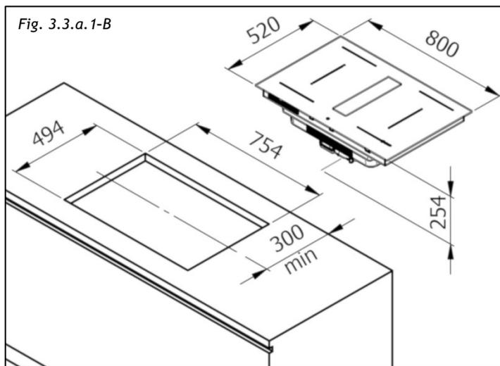
Pour effectuer l'INSTALLATION AFFLEURANTE, percer et fraiser le plan de travail le long du bord du trou d'installation, en respectant les mesures indiquées :
