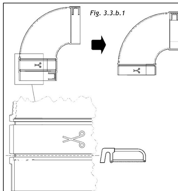
Pour permettre le logement correct du conduit d'évacuation, si celui-ci est prévu sous la plinthe du meuble, la partie inférieure du meuble doit être découpée comme indiqué en Fig. 3.3.b.2 et la partie arrière retirée si nécessaire.
