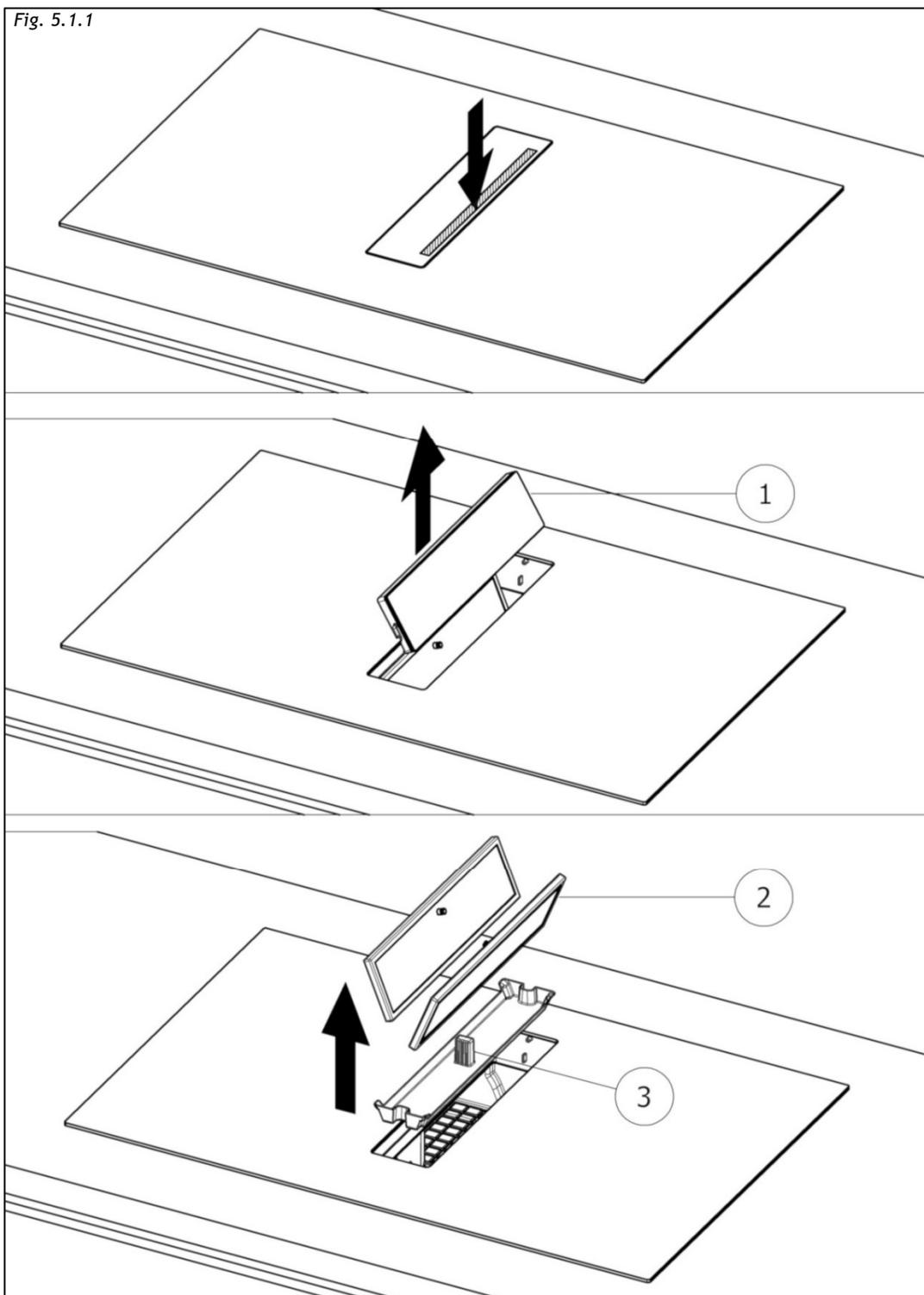
Après avoir réalisé ces opérations, il sera possible de nettoyer tous les composants tout juste extraits. À la fin du nettoyage, les composants doivent être séchés et repositionnés en suivant les opérations indiquées ci-dessus (Fig. 5.1.1) dans l'ordre inverse.
