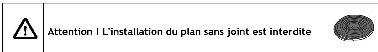
Retirer le film de protection et coller le joint à 2 mm du bord du verre (A=2 mm), sur les 4 côtés, sans le superposer dans les coins (Fig.3.10).
