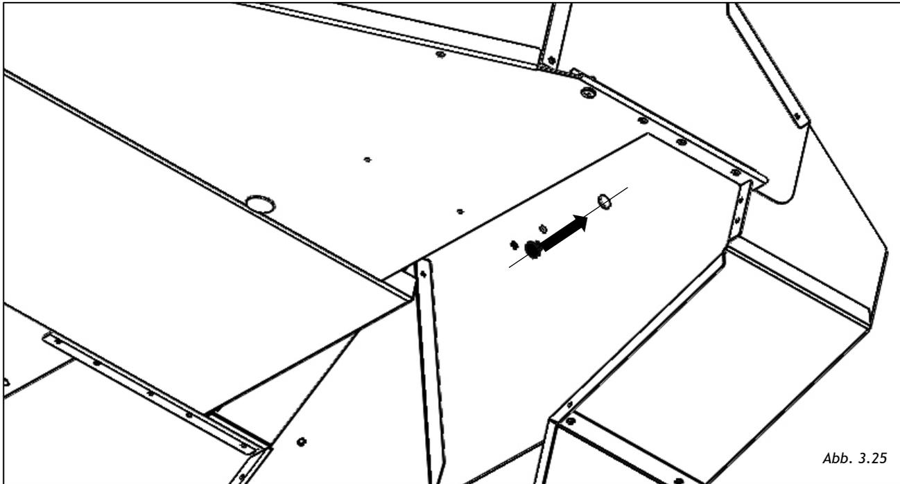
Fahren Sie dann mit dem Befestigen der 4 zuvor entfernten Schrauben fort (Abb. 3.26)
