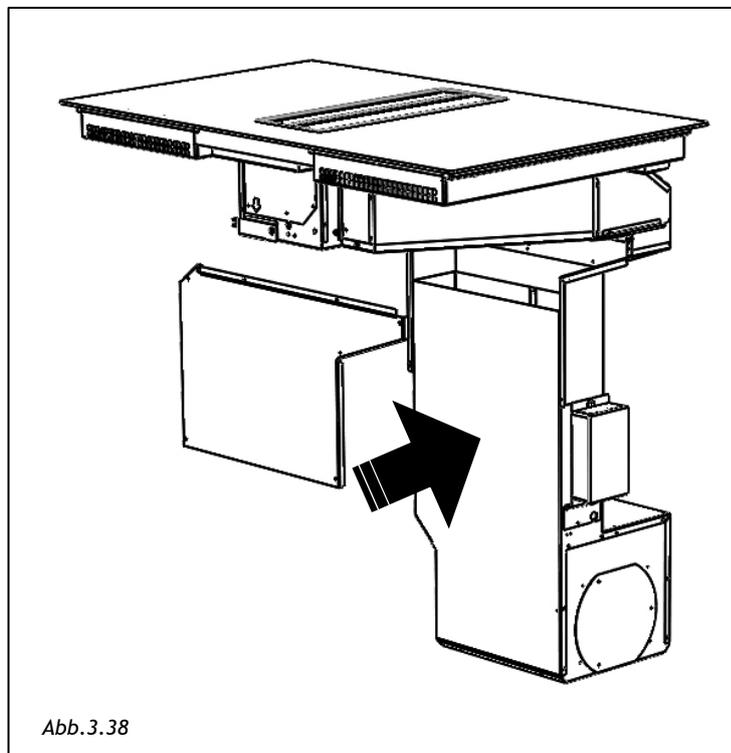
Jetzt ist es möglich, den Abluftaustritt für den Rauchaustritt durch die im Lieferumfang enthaltene Armatur nach außen zu verbinden (Abb. 3.18).
