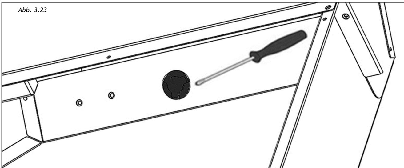
Nachdem der Anschluss aus der Abzueinheit entfernt wurde, muss die Verlängerung von Anschluss 1 entfernt und mit den 6 Schrauben, die die beiden Bleche miteinander verbinden, auf dem Anschluss 2 wieder montiert werden. 3.24
