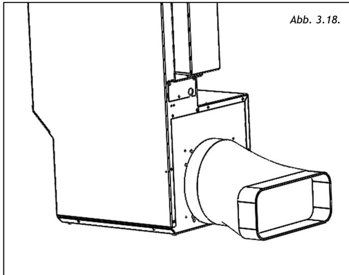
Um den Abluftkanal in die gewünschte Position zu bringen, muss das Rohr mit separat erhältlichen Zubehörteilen installiert werden (Abb. 3.19).
