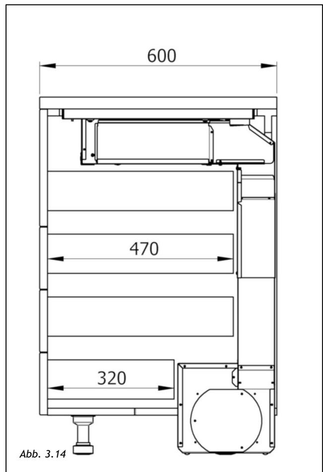
Die Tiefen der Schubladen sind Richtwerte und basiert auf einem Schrankunterbau mit Standardmaßen.
