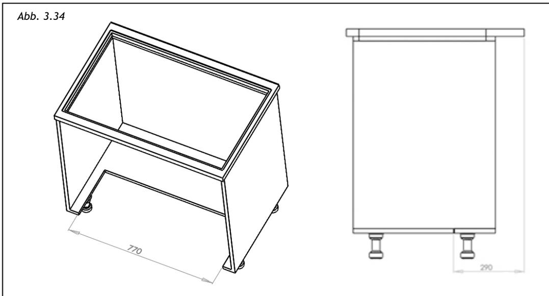
Der Einsatz dieses Absaugsystems erfordert eine maximal Länge für die eventuell unter dem Kochfeld vorgesehenen Schubladen: (Abb. 3.41):
