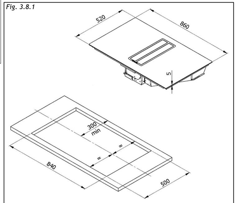
Für die bündige Montage: Bereiten Sie an der Arbeitsfläche einen Ausschnitt vor und fräsen Sie die Kanten der Installationsöffnung. Beachten Sie dabei die in Abb. 3 gezeigten Maße. 3.9.
