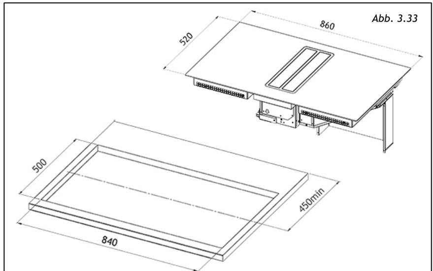
Für die bündige Montage: Bereiten Sie an der Arbeitsfläche einen Ausschnitt vor und fräsen Sie die Kanten der Installationsöffnung. Beachten Sie dabei die in Abb. 3 gezeigten Maße. 3.9.
