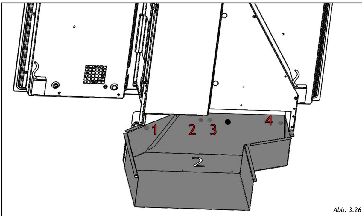
Bringen Sie an dieser Stelle die Eckabdeckung in der hintersten Position wieder an, um den durch den neuen Beschlag entstanden Platz abzudecken, und ziehen Sie die sieben Schrauben in Abb. 3.27
