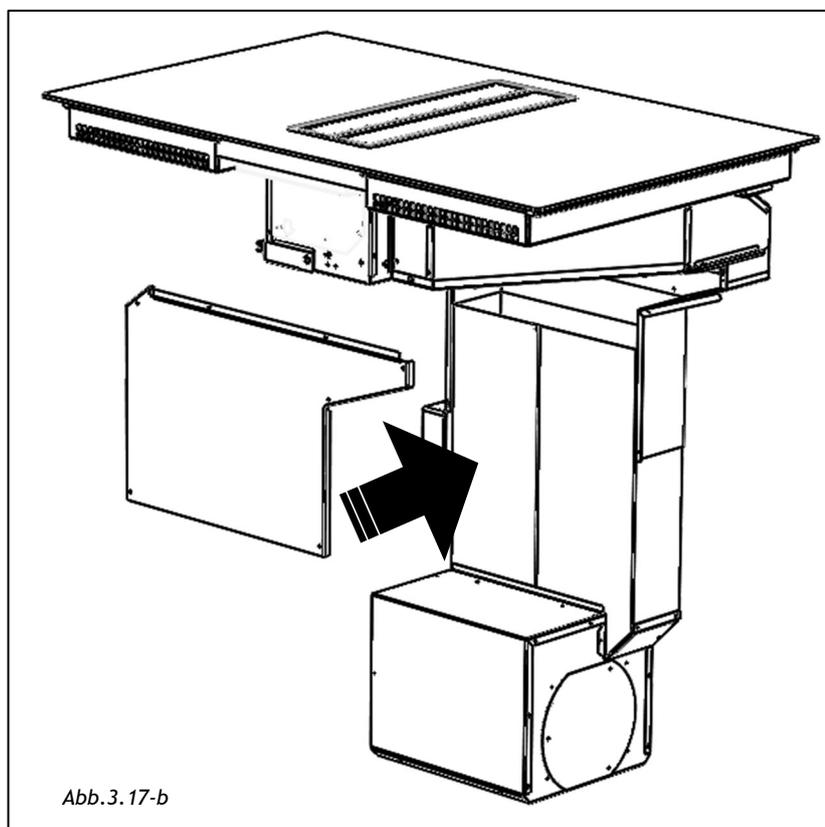
Jetzt ist es möglich, den Abluftaustritt für den Rauchaustritt durch die im Lieferumfang enthaltene Armatur nach außen zu verbinden (Abb. 3.18).
