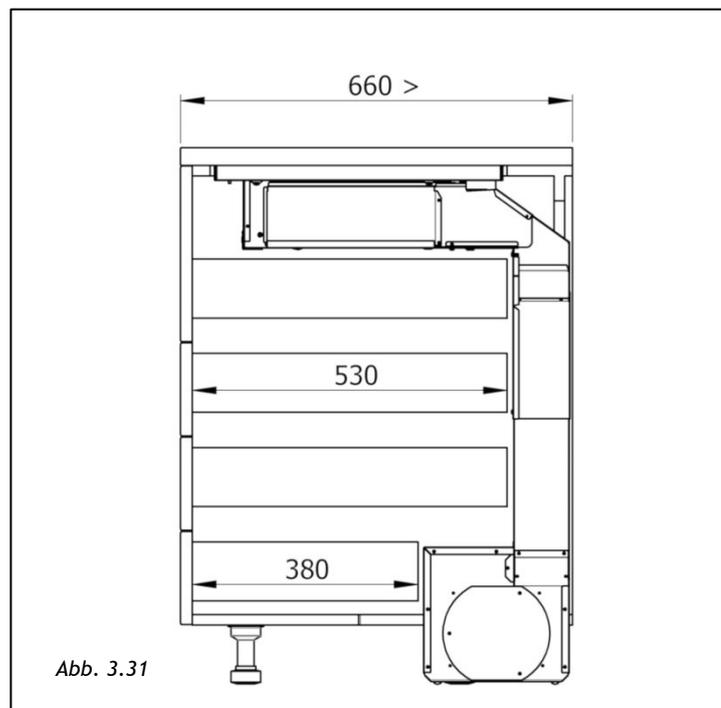
Die Tiefen der Schubladen sind Richtwerte und basiert auf einem Schrankunterbau mit Standardmaßen.
