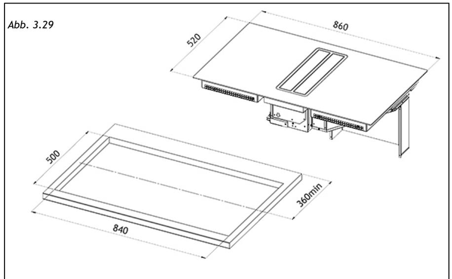
Für die bündige Montage: Bereiten Sie an der Arbeitsfläche einen Ausschnitt vor und fräsen Sie die Kanten der Installationsöffnung. Beachten Sie dabei die in Abb. 3 gezeigten Maße. 3.9.
