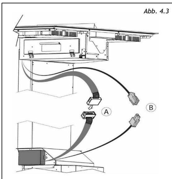
Das System besteht aus drei Geräten, die auf unabhängige Weise an das Stromnetz angeschlossen werden müssen: Die Schilder mit den Daten bezüglich der zulässigen Stromversorgung befinden sich an der Unterseite des Kochfelds und im oberen Abluftkanal.
