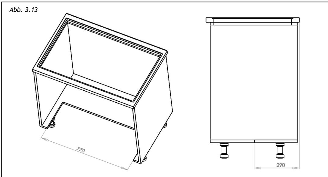
Der Einsatz dieses Absaugsystems erfordert eine maximal Länge für die eventuell unter dem Kochfeld vorgesehenen Schubladen (Abb. 3.14):
