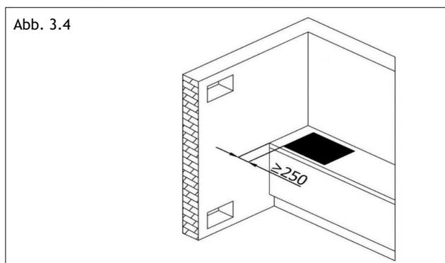
Wir empfehlen, das Gerät erst nach der Montage der Oberschränke zu installieren, um Schäden an der Glasplatte zu vermeiden.
