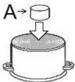
Es kann festgestellt werden, ob der Boden des Topfes mit einem kleinen Magneten (A) magnetisiert werden kann. Geeignet sind nur die Töpfe, von denen der Magnet angezogen wird.
