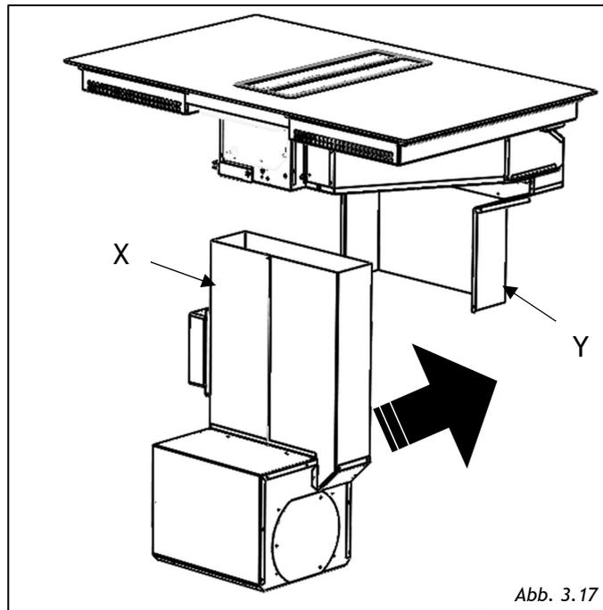
Befestigen Sie die Abdeckung mit den mitgelieferten Schrauben am vertikalen Rohr (Abb.3.17-b).
