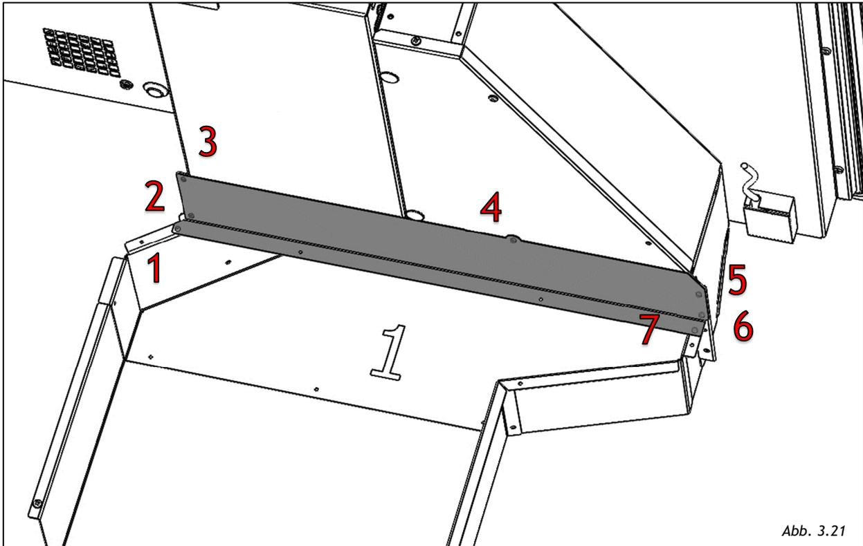
Wenn die Eckabdeckung entfernt wurde, entfernen Sie den Anschluss 1, indem Sie die Schrauben an der geneigten Wand lösen, wie in Abb. 3.22
