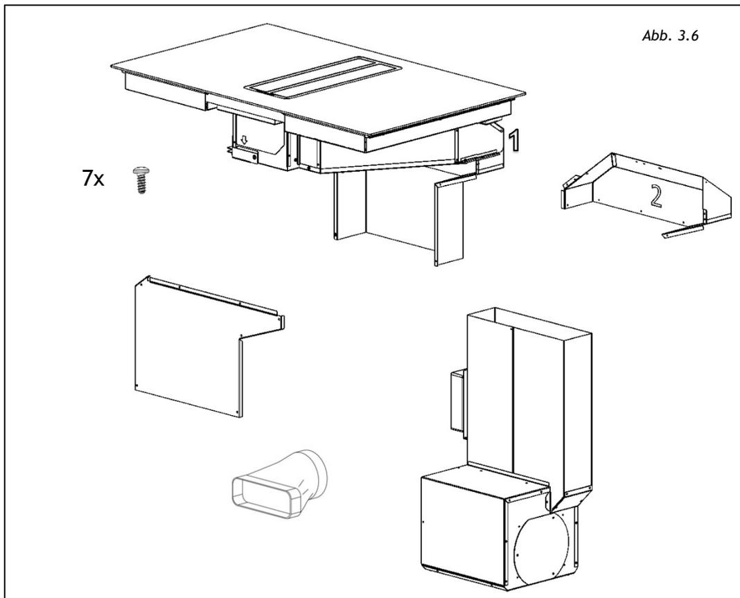
Fahren Sie mit dem Entfernen der Verbindung "1" fort
