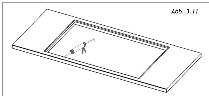
Dann das Silikondichtmittel bündig mit dem Ausschnitt (Abb. 3.11) verteilen und das Kochfeld platzieren (Abb.3.12)
