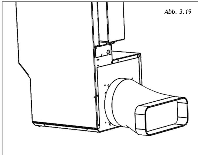
Um den Abluftkanal in die gewünschte Position zu bringen, muss das Rohr mit separat erhältlichen Zubehörteilen installiert werden (Abb. 3.20).
