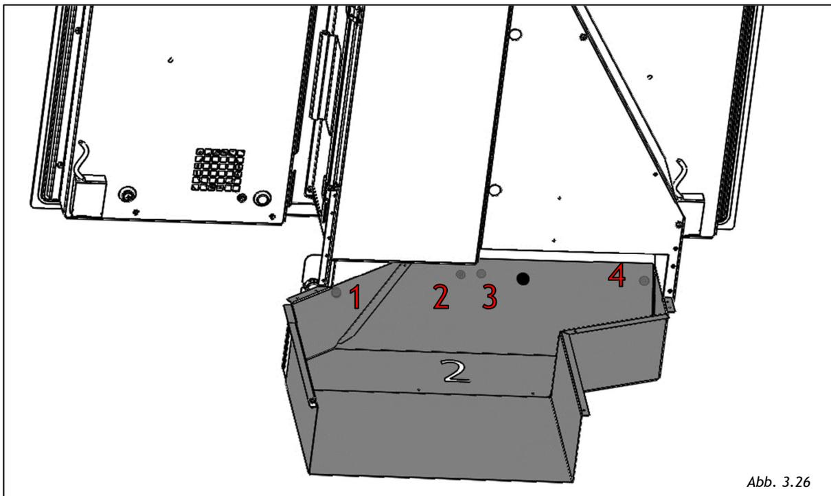
Bringen Sie an dieser Stelle die Eckabdeckung in der hintersten Position wieder an, um den durch den neuen Beschlag entstanden Platz abzudecken, und ziehen Sie die sieben Schrauben in Abb. 3.27. an.
