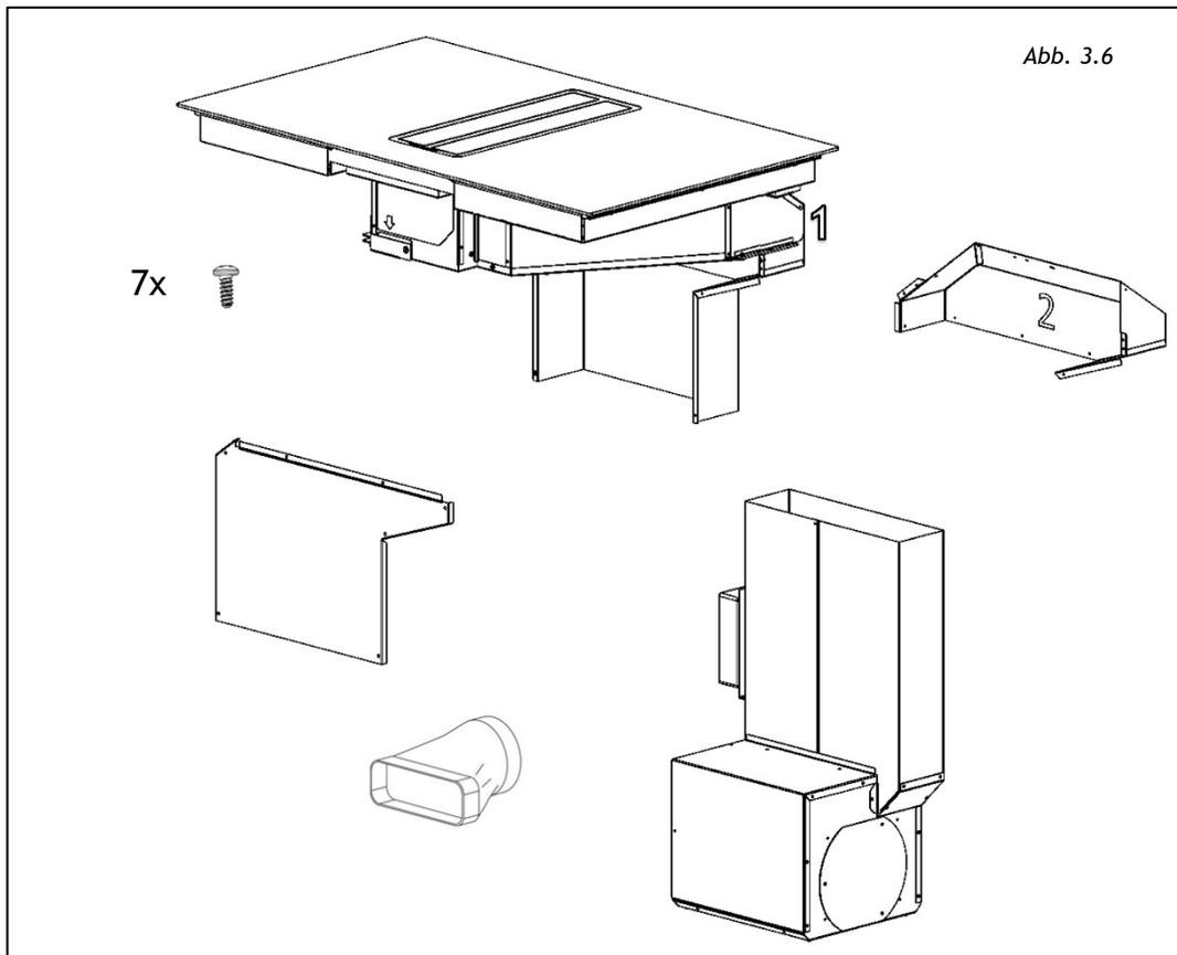
Die mit der Markierung "2" gekennzeichnete Ersatzarmatur an der Rückseite wird in dieser Konfiguration nicht verwendet.
