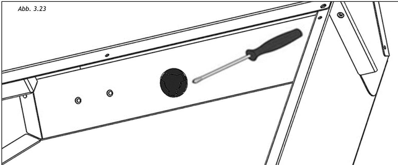
Nachdem der Anschluss aus der Abzugeinheit entfernt wurde, muss die Verlängerung von Anschluss 1 entfernt und mit den 6 Schrauben, die die beiden Bleche miteinander verbinden, auf dem Anschluss 2 wieder montiert werden. 3.24
