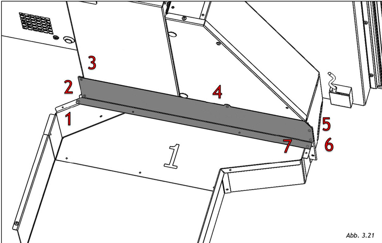
Wenn die Eckabdeckung entfernt wurde, entfernen Sie den Anschluss 1, indem Sie die Schrauben an der geneigten Wand lösen, wie in Abb. 3.22. gezeigt.
