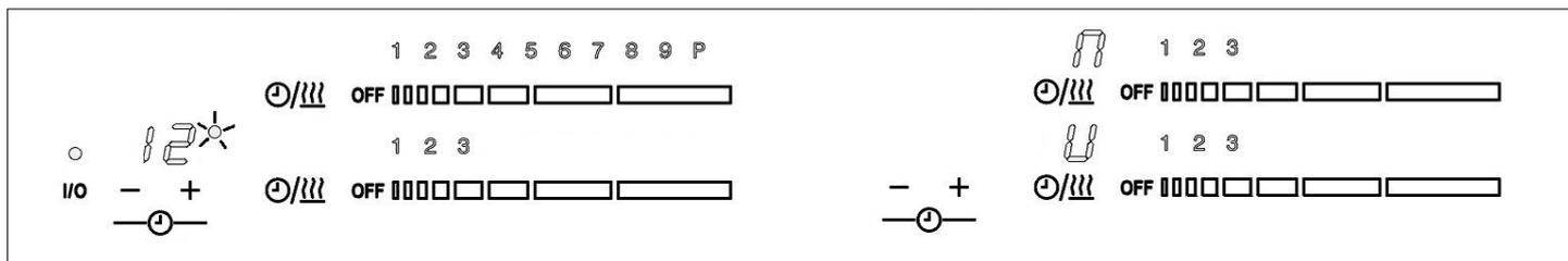
➤ Se il riscaldatore 1 e il riscaldatore 2 sono temporizzati contemporaneamente (Touch Control a sinistra): viene visualizzato il tempo più breve rimanente e il relativo LED del timer lampeggia. L'altro LED è acceso in modo continuo.
