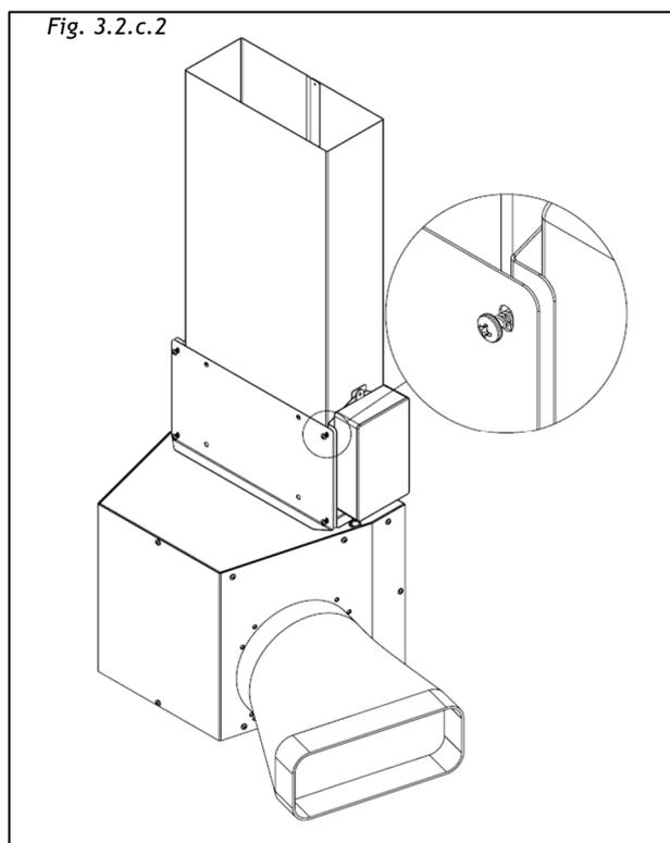
Il pannello frontale e il tubo vengono fissati insieme con 3 viti (Fig. 3.2.c.3), rimuovendole, il tubo può scorrere fino alla posizione superiore e poi può essere rifissato con le stesse viti.
