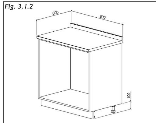
Il rivestimento del mobile deve essere trattato con colle termoresistenti (100°C) altrimenti, a causa di minore resistenza termica, può cambiare la forma e il colore.
