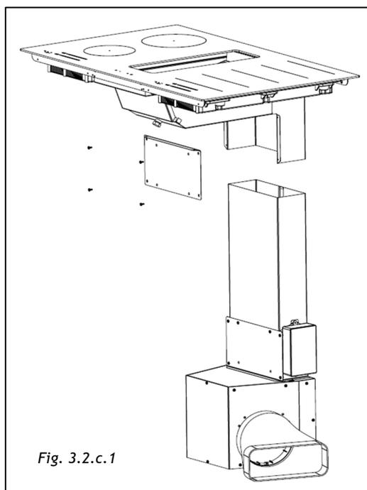
Se la lunghezza del tubo metallico non è sufficiente per raggiungere l'alloggiamento superiore è possibile aumentarla spostando il tubo all'interno del box motore.
