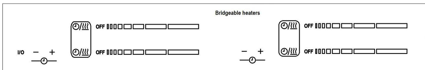
Per abilitare o disabilitare la funzione Bridge “Ponte”, l'utente deve premere una combinazione di tasti (entrambi i tasti di selezione dei riscaldatori collegabili a Bridge “Ponte”) e viene emesso un segnale acustico.
