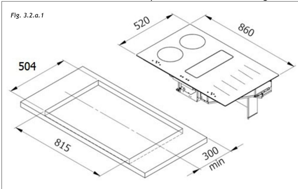
**INSTALLAZIONE A FILO:** forare il piano e fresare il piano di lavoro lungo il bordo del foro d'installazione, rispettando le misure indicate in Fig. 3.2.a.2.
