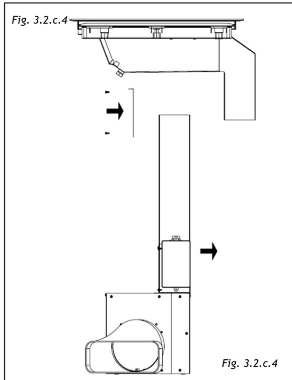
Per alloggiare correttamente i tubi di scarico aria, è necessario usare tubazioni e raccordi che permettano di passare sotto i mobili della cucina, nello spazio tra la base dei mobili e il pavimento, normalmente coperto da uno zoccolo.
